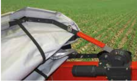
Elektrisch fernbedienbare Abdeckplane
