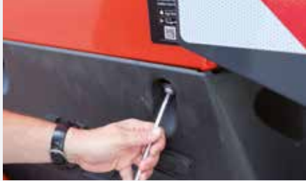
Schmutzfänger mit Schnellverschluss
