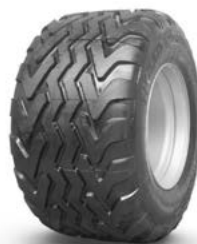
Radialreifen 620/40 R22.5 TL Breite: 610 mm Ø: 1.080 mm
