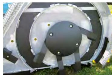
Die Rotationsmulcher sind mit austauschbaren Panzerblechen zur Schadensvermeidung ausgestattet. Weiterhin ist jeder Rotor durch ein starkes Gehäuse geschützt. So ist eine sehr flache Arbeit über der Oberfläche möglich ohne Angst vor Beschädigung durch Steine.
