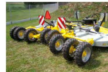
Der Rotationsmulcher MM 7000 hat 8 Räder in der Grundausstattung. Der Rotationsmulcher MZ hat 6 Räder in der Grundausstattung, kann aber auf 8 Reifen kundenspezifisch erweitert werden. Die Reifen können auf Wunsch ausgeschäumt werden, um Reifenschäden bei Einsatz in Dornenbüschen zu verhindern.
