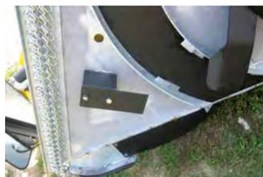
Die vorderen Mulchzonen sind mit Gegenschneiden ausgestattet, um den Zerkleinerungseffekt zu erhöhen und die Zerschneidung des gemulchten Materials zu vervollständigen. Die Qualität des gemulchten Materials wird verbessert. Besonders wichtig gegen den Maiszünsler.
