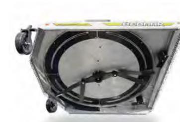
Der untere Rotorenteil der MO Maschine ist vergleichbar mit den Typen MZ und MM, d.h. 4 Klingen pro Rotor, Panzerung, vordere Gegenklinge und Streubleche. Die Kombination dieser Komponenten sichert Qualitätsarbeit unter allen Bedingungen.
