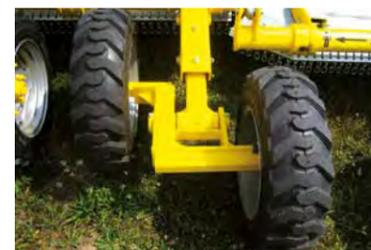
Die zentrale Schreitachse erleichtert es Unebenheiten zu überwinden und dabei die Arbeitshöhe einzuhalten. Dank der Achse arbeitet die Maschine gleitend auch auf sehr unebenen Feldern und Weiden.
