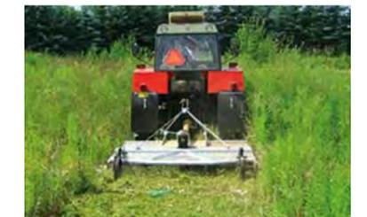
Der MO Rotationsmulcher kann mit hinteren Stützrädern ausgerüstet werden, die die Zugkraft minimieren und gleichzeitig dem Traktor helfen nur einen Teil der Maschinenlast zu tragen.
