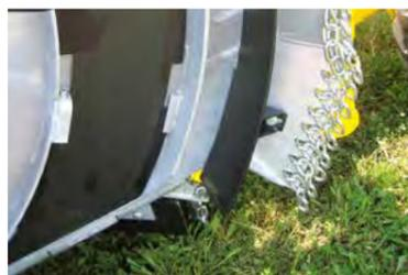
Die perfekte Maschinenarbeit wird durch Streubleche gesichert, die das gemulchte Material gleichmäßig auf dem Feld verteilen. Pflanzliche Anhäufungen/Schwadbildung werden verhindert.
