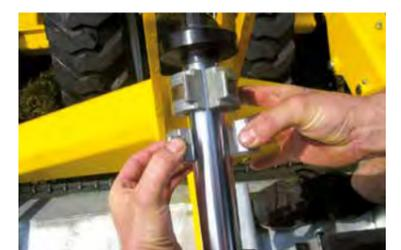
Die Mulchhöhe der MZ und MM Maschinen wird zentral mit Hilfe von Hydroclips an den hydraulischen Zylindern der zentralen Schreitachse eingestellt. Die Einstellung ist sehr einfach, schnell und bequem.
