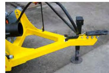
Die Rotationsmulcher MZ und MM werden an der oberen oder unteren Traktoranhängung mit einer Zugöse des Durchmessers 40 oder 50 mm befestigt, Scharmüller K80 Kugelumkupplung ist ebenfalls möglich.
