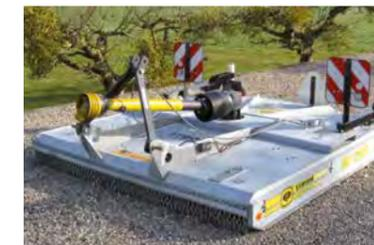
Die Mulchhöhe des Types MO wird an den Unterlenkerarmen eingestellt, eventuell an den hinteren Stützrädern mit Hilfe von Distanzscheiben.
