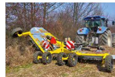
Die Flügel des MZ und MM Rotationsmulchers arbeiten auf schwingenden Armen und bearbeiten unebene Mulchfelder im Winkel von -15° to +45° perfekt. Die Maschine mit den Flügeln in +45° Position kann zum Säubern von Strassenrändern, Weiderändern und Feldern genutzt werden.
