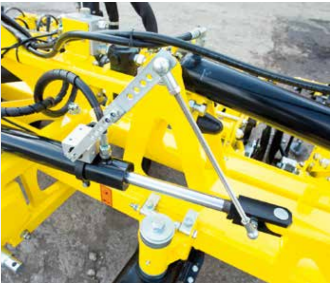
Sensor der aktuellen Lage des Maschinenrahmens gegenüber der 3-Punkt-Aufhängung.
