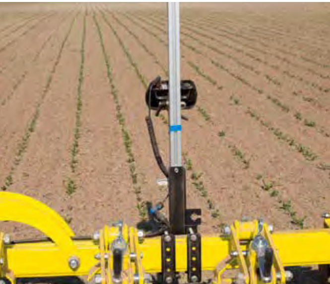
Die Höhe und den Schwenkwinkel der Kamera können je nach aktuellem Wachstumsstadium des Bestands eingestellt werden.
