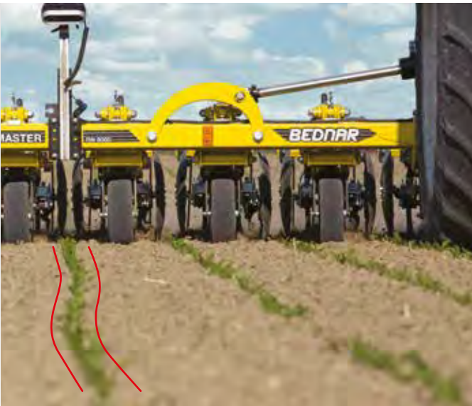
Das Selbststeuerungssystem ist in der Lage den Row-Master auch in dem Fall anzusteuern, wenn die Früchte in einem Bogen ausgesät wurden.
