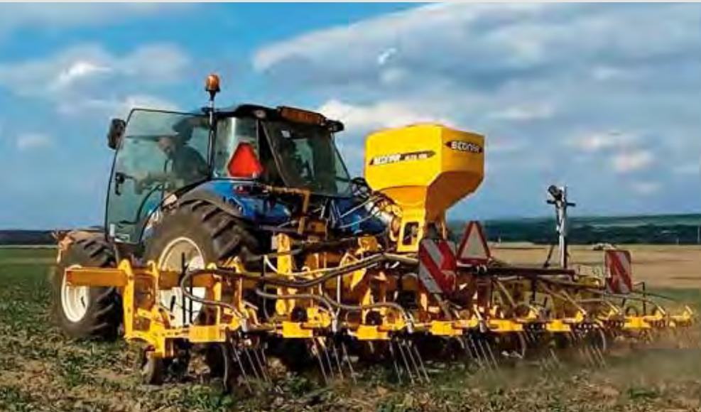
Das Hacken kann die ganze Technologie sehr intensivieren, vor allem wenn die Hackmaschine die Möglichkeit einer Zudüngung oder eines Streifenspritzens hat. Die Senkung der Gesamtdosis an chemischen Stoffen ist ein weiteres großes Plus der beschriebenen Technologie, da es ausreicht, mit dem Streifenspritzen das Herbizid lediglich auf ein Drittel der Fläche auszubringen.
