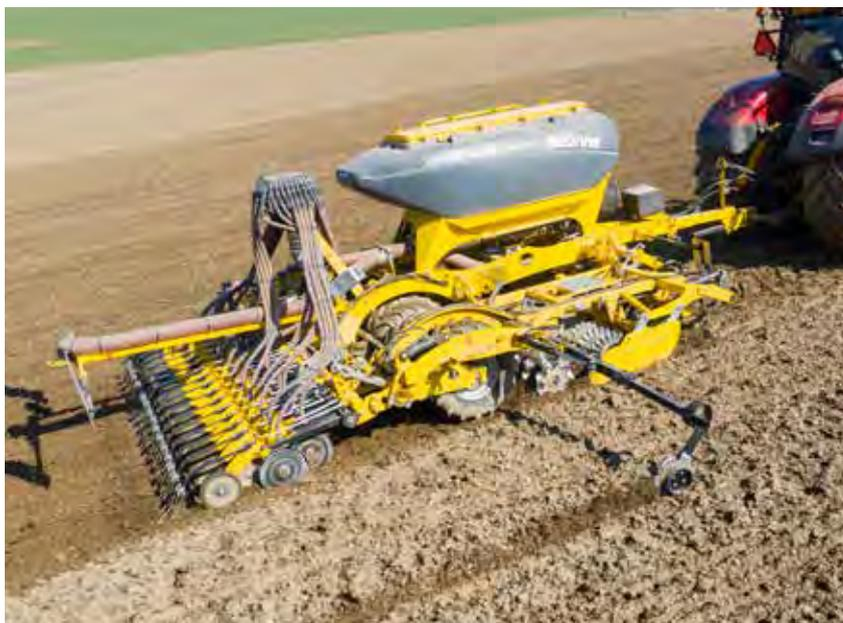
Bei einer Arbeit ohne Navigation kann die Drillmaschine OMEGA mit seitlichen hydraulisch gesteuerten Markierern ausgestattet werden.
