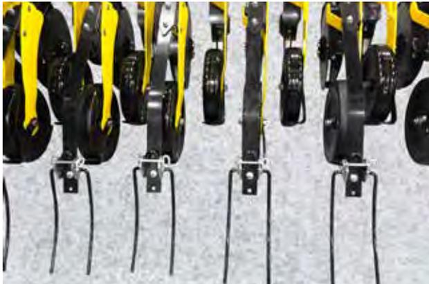
Abstand zwischen den Reihen 16,7 cm bei Bedingungen mit B331höheren Niederschlägen oder mit einer gewöhnlich großen Menge von Pflanzenresten auf dem Boden.
