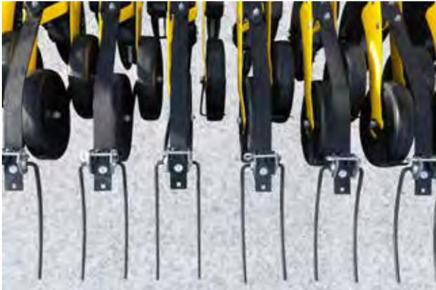
Abstand zwischen den Reihen 12,5 cm für die Mehrheit der Bedingungen mit einem größeren Anteil von Getreide bei der Saat. Möglichkeit der Saat von Winterraps in jede zweite Reihe mit einem Reihenabstand von 25 cm, gegebenenfalls in jede dritte Reihe mit einem Reihenabstand von 37,5 cm.
