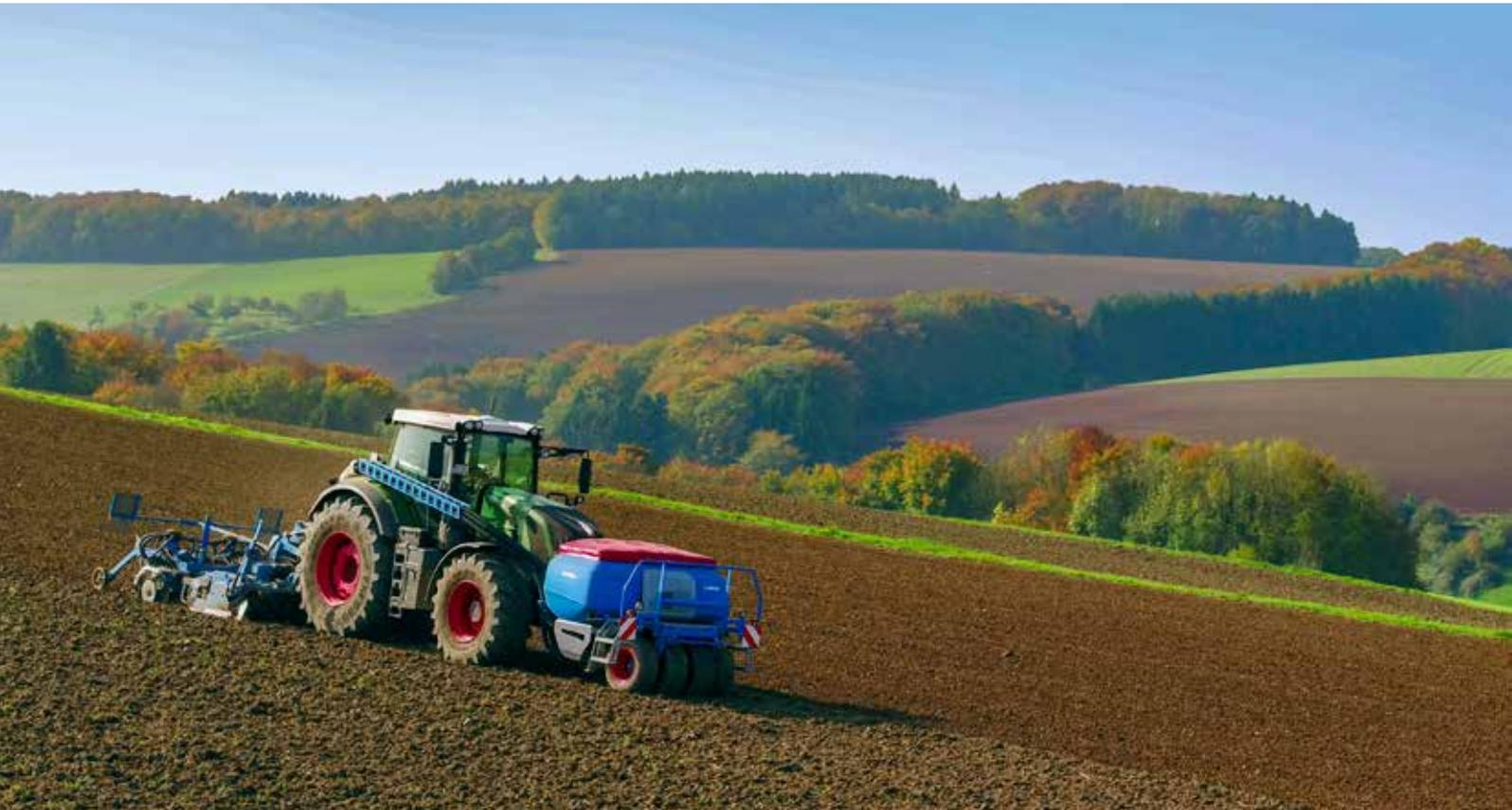
Der Fronttank Solitair 23 lässt sich flexibel mit dem Einzelkornsäegerät Azurit oder der Säschiene OptiDisc 25 kombinieren. Dadurch kann der Fronttank über das Jahr hinweg optimal ausgelastet werden. Die ausgewogene Gewichtsverteilung einer Front- und Heckkombination sorgt nicht nur
