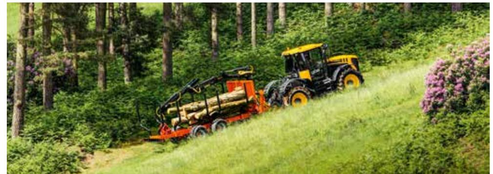
Die Allradlenkung reduziert den Wendekreis des Traktors auf weniger als 10 m (Bereifungsabhängig). Mit einem Positionsschalter kann der Bediener schnell zwischen Vorderradlenkung, Allradlenkung und einer vollständig vom Benutzer programmierbaren Einstellung umschalten.
