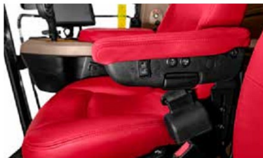
Luftfederter Sitz oder belüfteter, beheizter und semiaktiver Ledersitz und bequem erreichbare Bedienelemente für einen luxuriösen Komfort wie in einem Automobil
