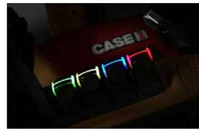
Konfigurierbare Bedienelemente mit wechselnden Farben ermöglichen die individuelle Zuordnung der Hecksteuergeräte in der Armlehne.
