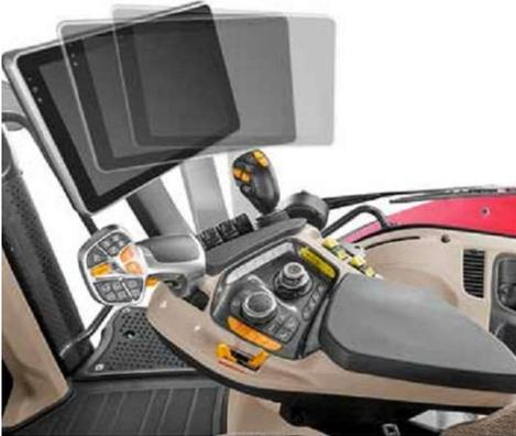
Für eine optimale Positionierung kann der Bildschirm um 52 Grad geschwenkt werden.
