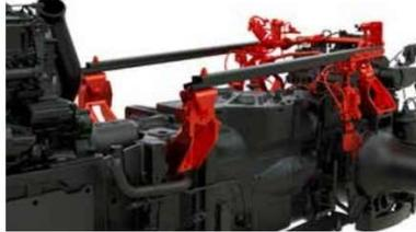
Die semi-aktive hydraulische Kabinenfederung absorbiert zuverlässig Stöße und Schwingungen.
