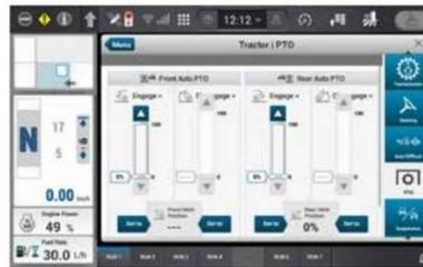
Intuitive Einstellung der automatischen Zu- und Abschaltung der höhenabhängigen Zapfwellenautomatik. Für Front- und Heckzapfwelle.
