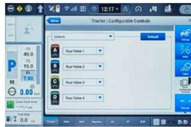
Über Schnellzugriffstasten gelangen Sie direkt in das Einstellungsmenü zur individuellen Konfiguration der Steuergeräte.
